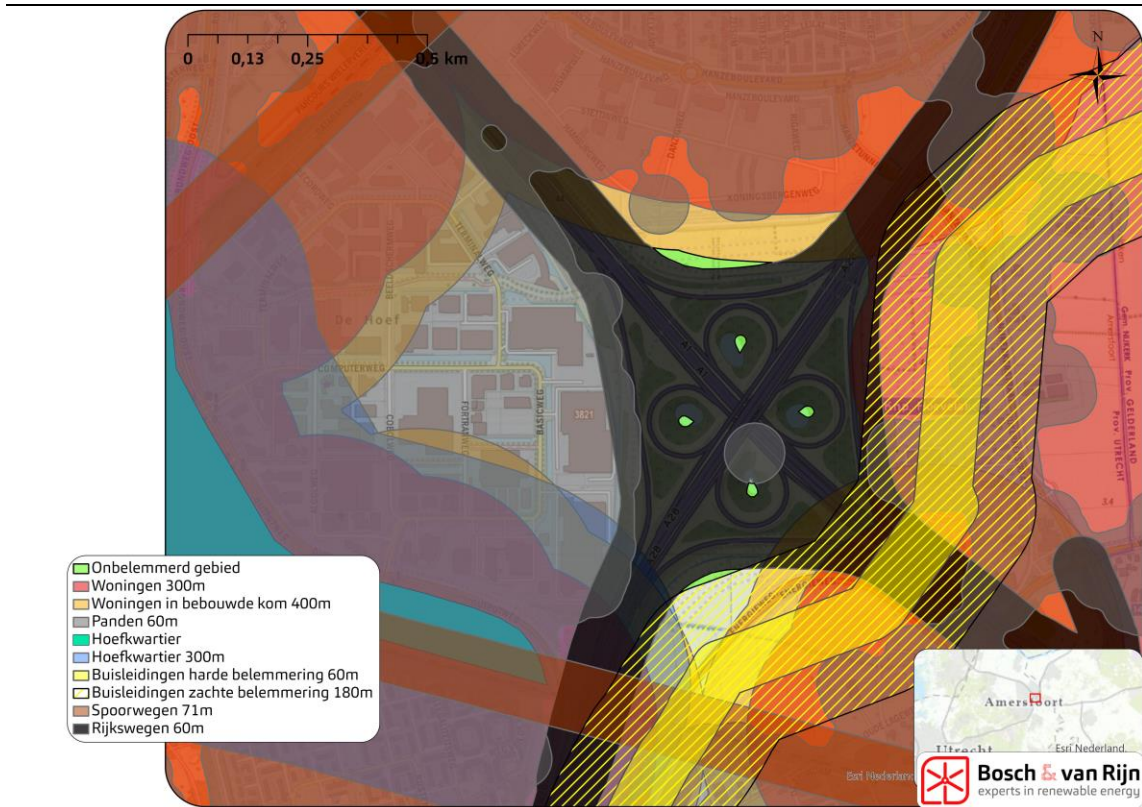
Figuur 3 Belemmeringenkaart Knooppunt Hoevelaken (ashoogte 120m / rotordiameter 120m)
